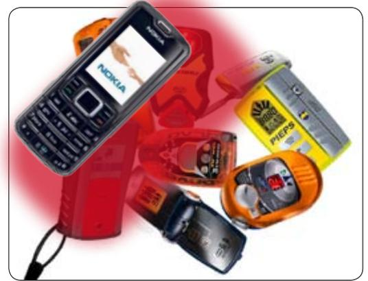
Die digitalen LVS-Geräte der jüngsten Generation mit 3-Antennen-Funksystem und ausgeklügelter Software ermöglichen eine sehr schnelle Ortung eines Lawinenschütteten. Die hochsensible Elektronik birgt jedoch auch Risiken, wie sich im Rettungswesen des vergangenen Winters herausgestellt hat:
